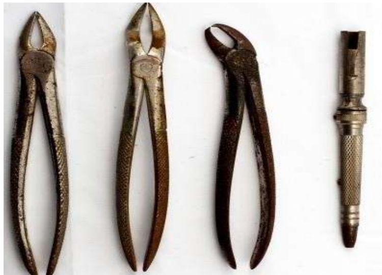
31 сурет-Коррозияға ұшыраған аспаптар
